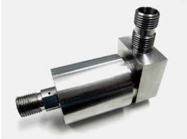
スイベルジョイントは主に油圧ホースに使用される、「圧力のある流体を固定配管側から上下、左右などの任意の方向に移動する機械装置側へ供給する場合に、ホースのねじれ防止や、曲げ半径緩和を主目的として使用される揺動継手」のことで、シャベルカーのアーム部などに使用されることが多い部品です。
