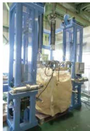
するため安全で、吸引抜き取り式のため、発塵も最小に抑えられます。袋外部に付着した異物も混入しません。こうした大きな化繊織の袋は通常、吸引不能となった残留分の発生が問題点としてありましたが、「パウダーワープF」は、ロードセル（重量秤）による制御により、内容物が残り少なくなってきた時点で左右のプッシャーにより粉体を中央に押し集め、左右の吊り下げ機構を交互に昇降させることで更に効率の良い吸引を促します。これにより、残留内容物の低減が可能となりました。なお当該製品は現在、これらの機構（方式）に関して特許出願中で、知的財産権保護の観点からも対策が進められております。
